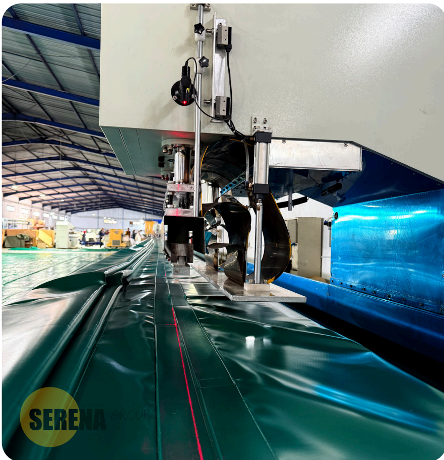
Machine de soudure Haute Frequence sur table de 30 mètres de long
