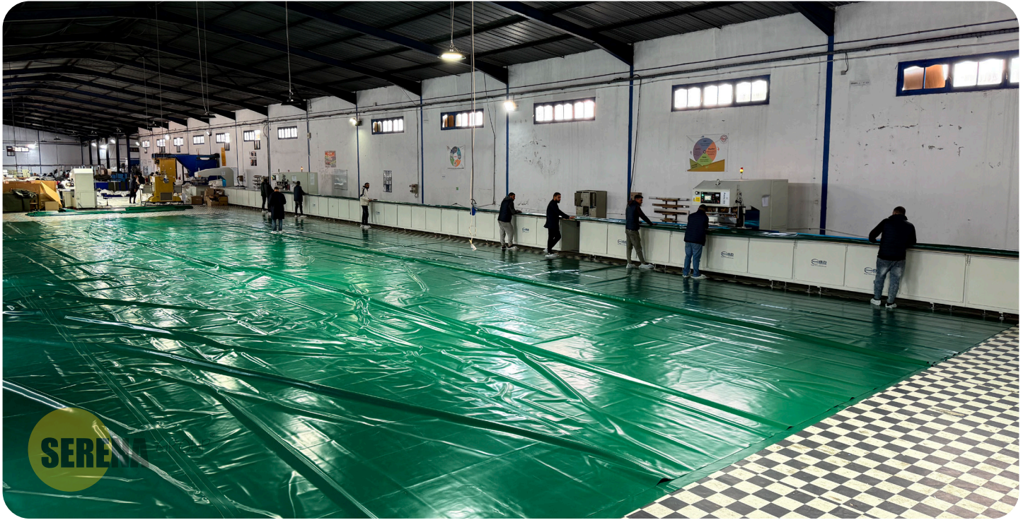
Fabrication d'une citerne de 1000 m 3
